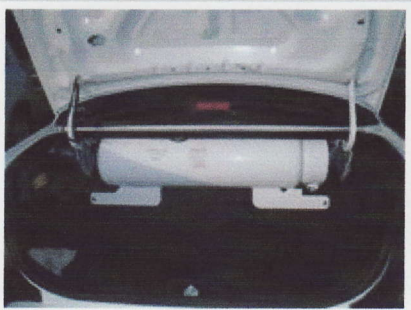
Le réservoir est solidement harnaché dans le coffre à bagages. (Photo Le Soleil - N.M.)
